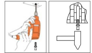
Element mocujący dobrać odpowiedni dla materiału podłoża.
