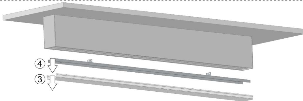
Po zamontowaniu oprawy do sufitu, płytę montażową LED i przesłonę włóż do oprawy. / After mounting the luminaire to the ceiling, attach the LED mounting plate and the diffuser to the luminaire.
