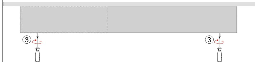
Zamontuj (przyklej) maskownice w miejscu łączenia modułów. / Install (glue) the masking panels in module connection point.
