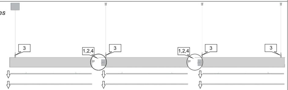
Z modułu zasilającego zdemontuj boczec, zaczep i wkręty, i zamontuj je na końcu ostatniego modułu w odwrotnej kolejności do pokazanego sposobu demontażu.
