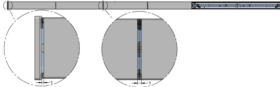
PL: - wyłączyć oprawy, a następnie, niezwłocznie, zainstalować przesłonę w ostatniej oprawie. Jeżeli będzie to wymagane, przesłonę należy skrócić, zachowując dystans około 1 mm do przesłony w sąsiedniej oprawie.
