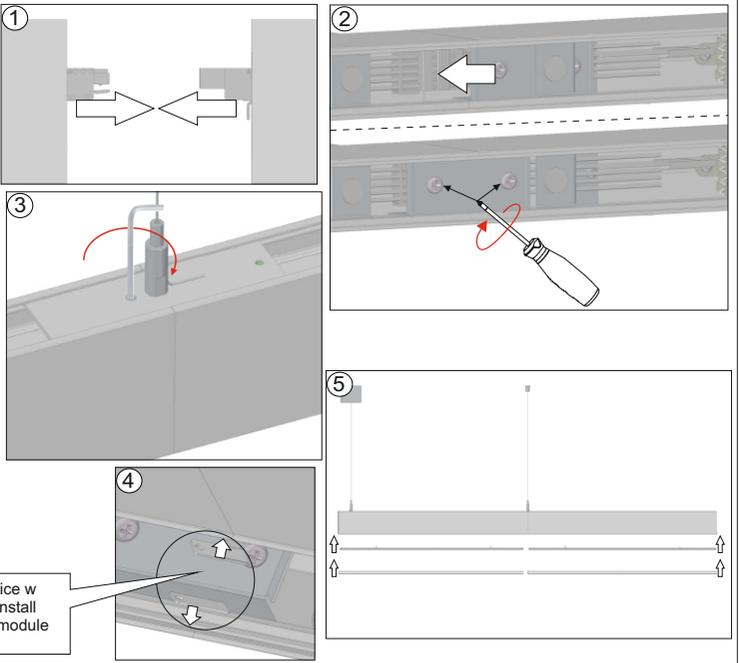
Zamontuj (przyklej) maskownice w miejscu łączenia modułów. / Install (glue) the masking panels in module connection point.
