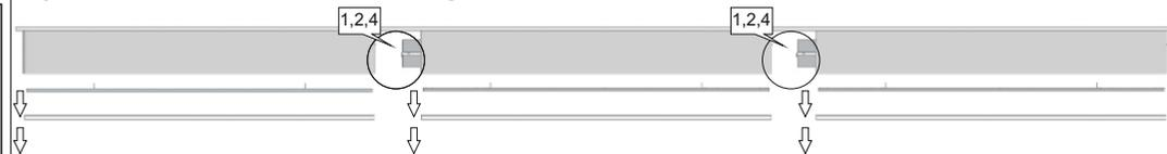
Z modułu zasilającego zdemontuj boczec, zaczepek i wkręty, i zamontuj je na końcu ostatniego modułu w odwrotnej kolejności do pokazanego sposobu demontażu. From the feeding module, remove the cap, the suspension plate and the screws and install them in reverse order disassembly shown.
